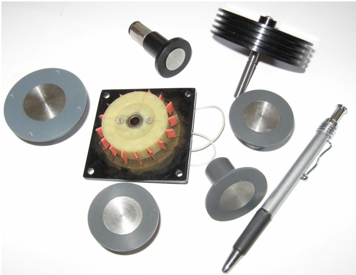
**Рисунок 12**, - на рисунке показаны различные варианты и размеры аэродинамических бесконтактных хватных устройств и разобранный пьезоэлектрический двигатель, работающий на принципе обратного пьезоэлектрического эффекта; На пьезокерамическом кольце закреплены толкающие пластины (в изоляции красного цвета); Такая конструкция позволяет получить на роторе высокий крутящий момент при стабильном угле поворота ротора. Также на рисунке прослеживается масштабный фактор приведенных устройств.
