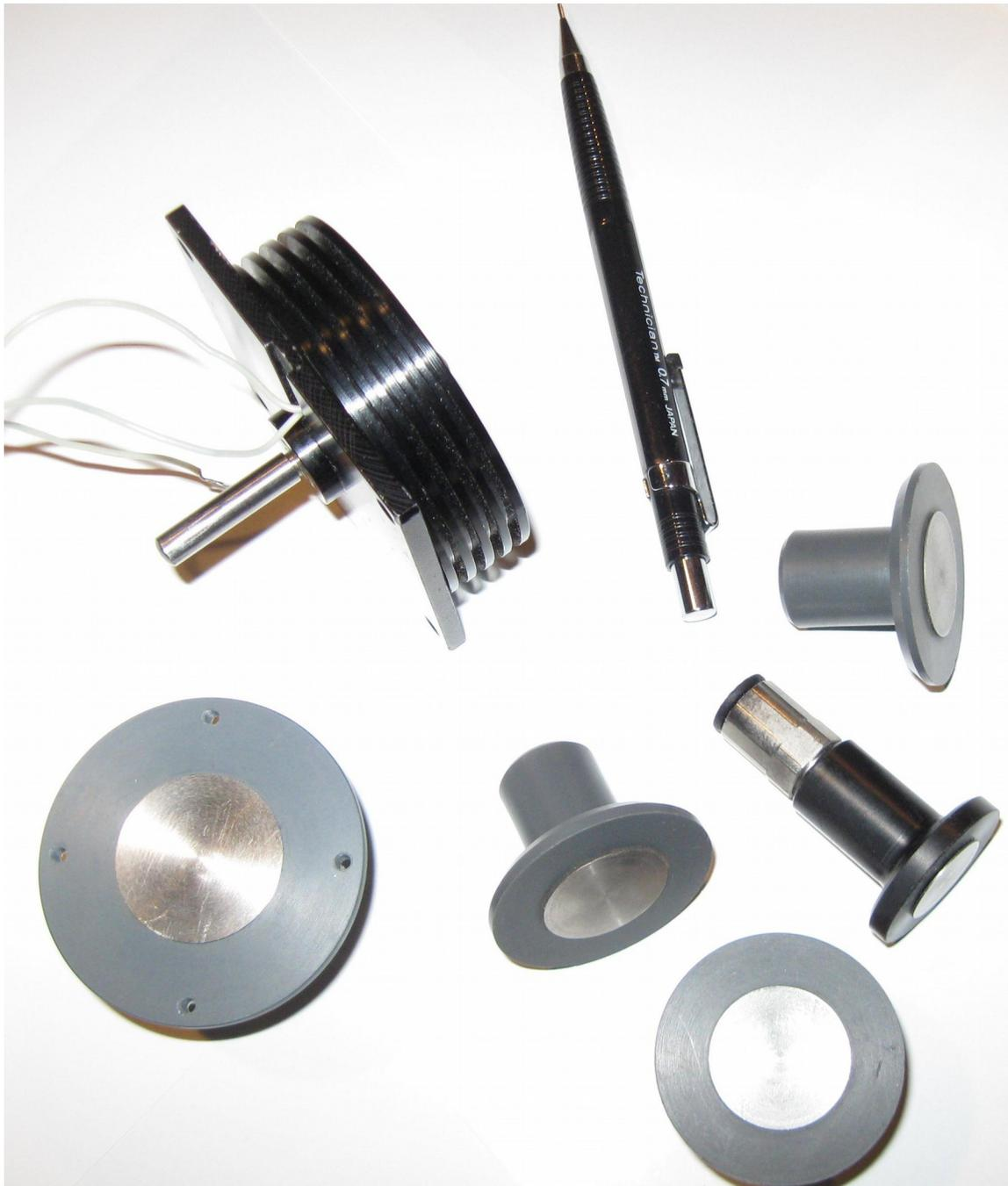
**Рисунок 13**, - на рисунке также показаны различные варианты и размеры аэродинамических бесконтактных захватных устройств и собранный пьезоэлектрический двигатель , работающий на принципе обратного пьезоэлектрического эффекта; На пьезокерамическом кольце двигателя закреплены толкающие пластины – лепестки ;
