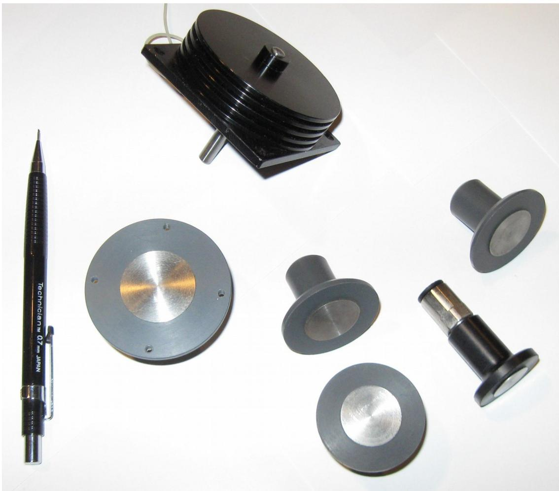
**Рисунок 1** , - на рисунке показаны различные варианты и исполнительные размеры аэродинамических бесконтактных захватов , которые также могут выполнять функции генераторов пены.
