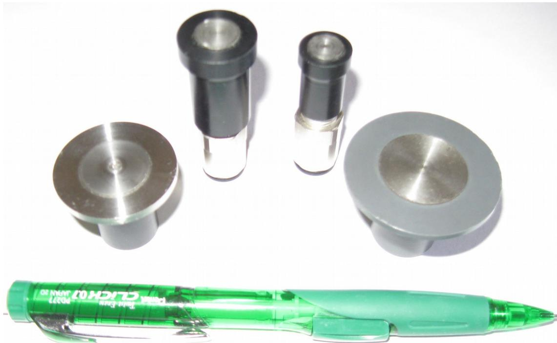
**Рисунок 10,** - на рисунке показаны различные типы и размеры аэродинамических хватных устройств с мембранами из нержавеющей стали и корпусами , изготовленными из различных синтетических материалов, в том числе из терморезистивных пластмасс и из термопластичных пластмасс.
