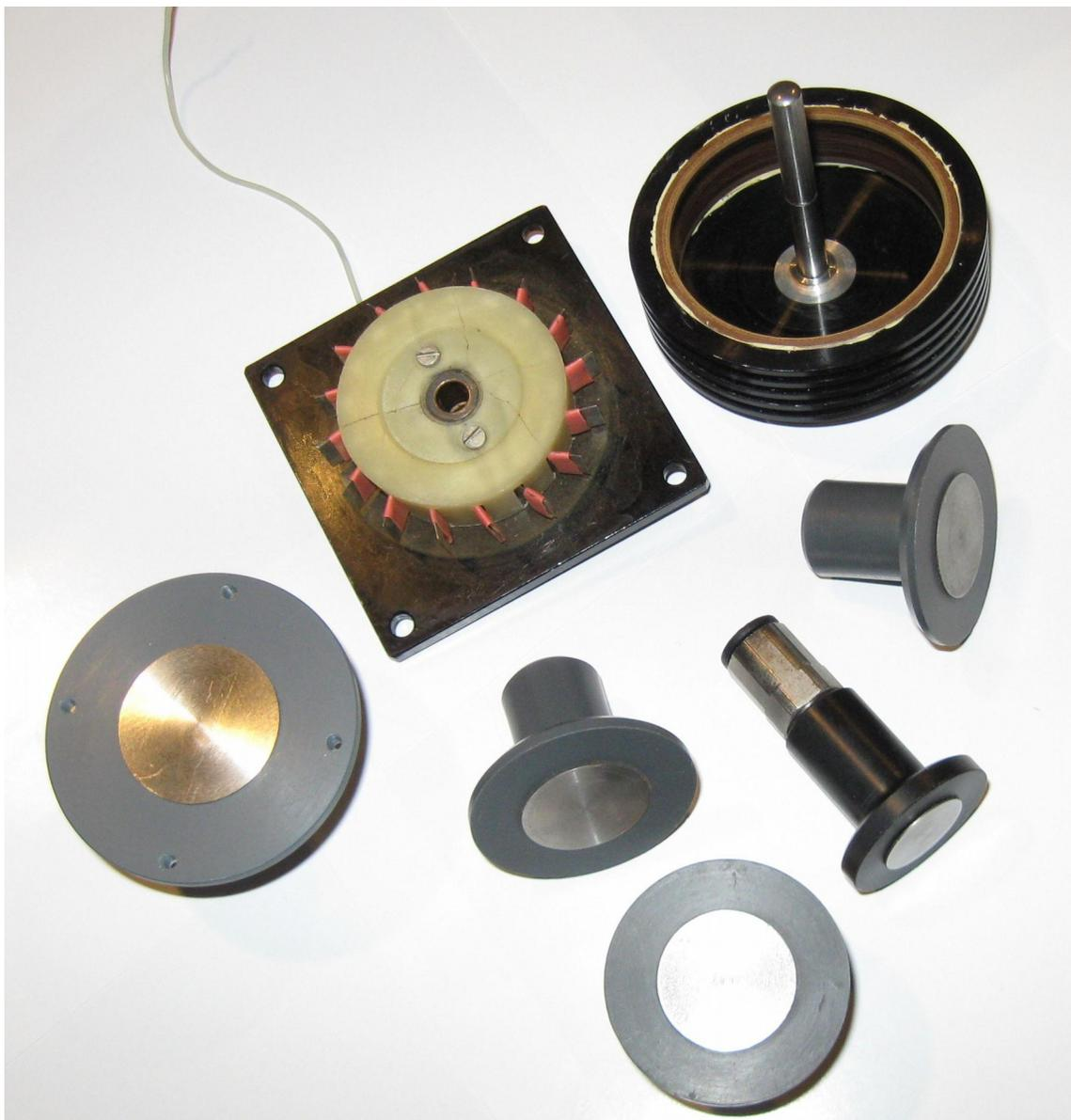
**Рисунок 11**, - на рисунке также показаны различные типы и размеры аэродинамических захватных устройств с мембранами из нержавеющей стали и корпусами, изготовленными из различных синтетических материалов , в том числе из термореактивных пластмасс и из термопластичных пластмасс.
