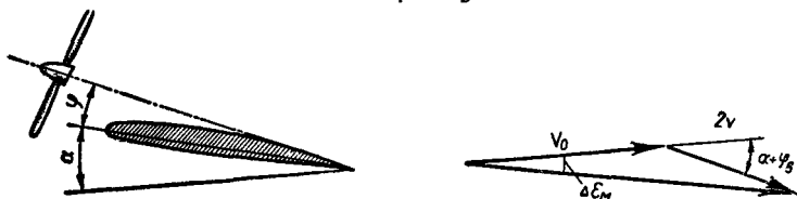
Рис. 81. Нахождение скоса потока от винта
