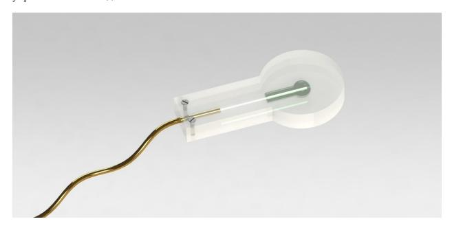
На следующем фото показана мини-лампа в которой на конец оптического кабеля по определённой геометрии в трёхмерной системе координат нанесена смесь люминофоров , обеспечивающая свечение ( излучение ) в белом диапазоне спектра
