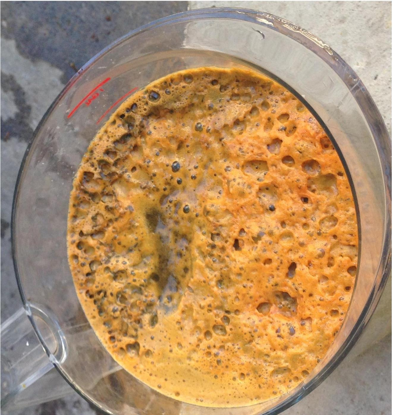
**Рис.3.** Слой пены, полученный при помощи пеногенератора на сточных водах современного производства моторного масла
