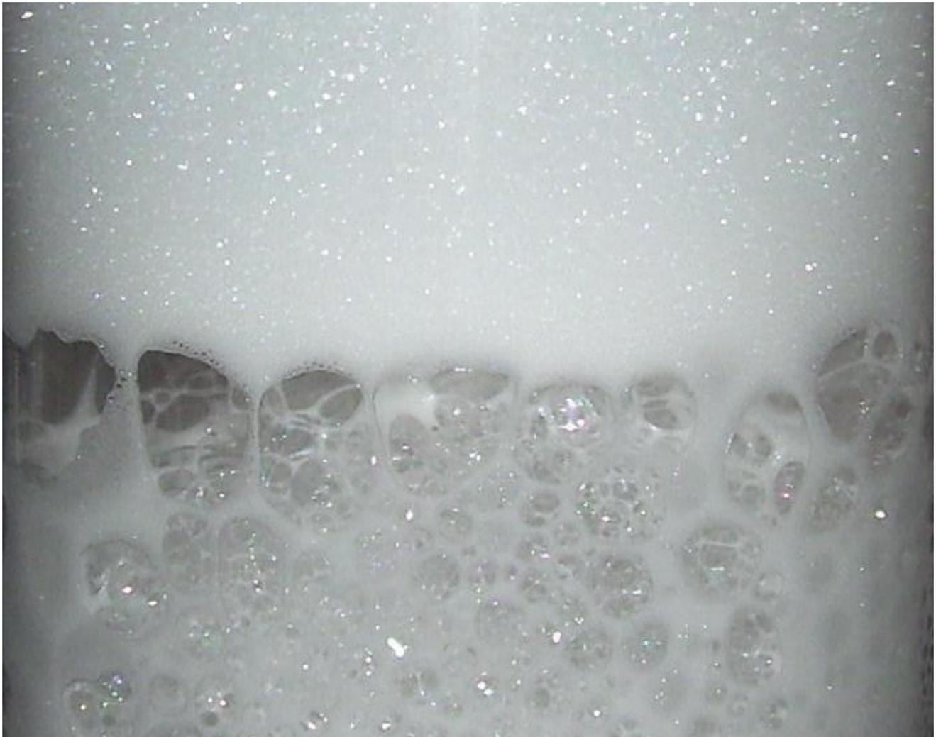
**Рис.1.** Лёгкость и точность регулировки диаметра воздушных пузырьков в пене. Видно как формат пены в одной и той же жидкости, в одной и той же ёмкости может меняться при изменении зазора между мембраной и корпусом
