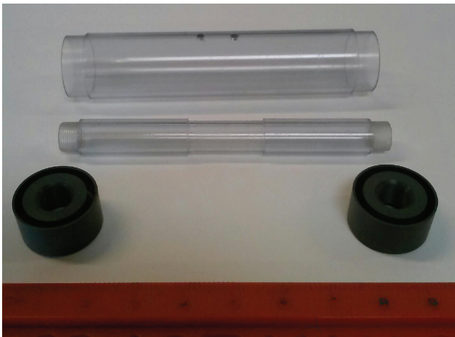
Рисунок 5. Детали мелкомасштабных капсул для контроля кислотности желудочного сока у коровы
