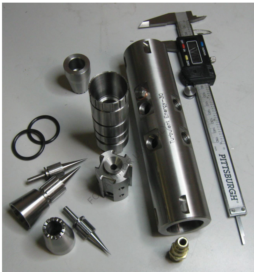
Рисунок 12. Элементы строения динамического смешивания и гомогенизации
