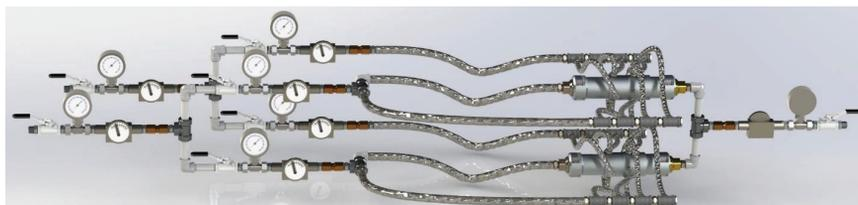
**Рисунок 3.** Модернизированная дублированная техническая система для станции линейной гомогенизации жидкого топлива в топливной системе промышленного бойлера, производительностью 10 тонн пара в час
