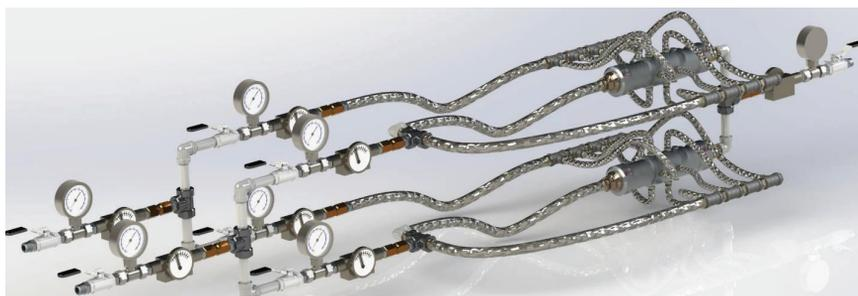
**Рисунок 4.** Системно-модернизированная дублированная техническая система для станции линейной гомогенизации жидкого топлива в топливной системе промышленного бойлера, производительностью 10 тонн пара в час
