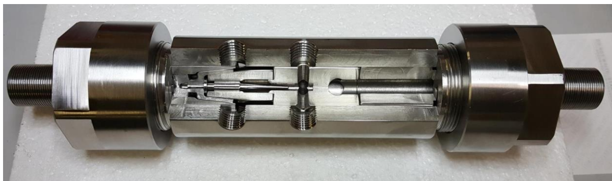
Рисунок 2 , - внутреннее устройство системы для он-лайн смешивания , гомогенизации и стабилизации турбулентного режима потока топливной смеси
