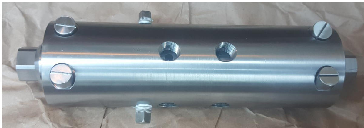
Рисунок 4 , - система с рабочим диаметром 30 миллиметров , подготовленная к установке на испытательный стенд
