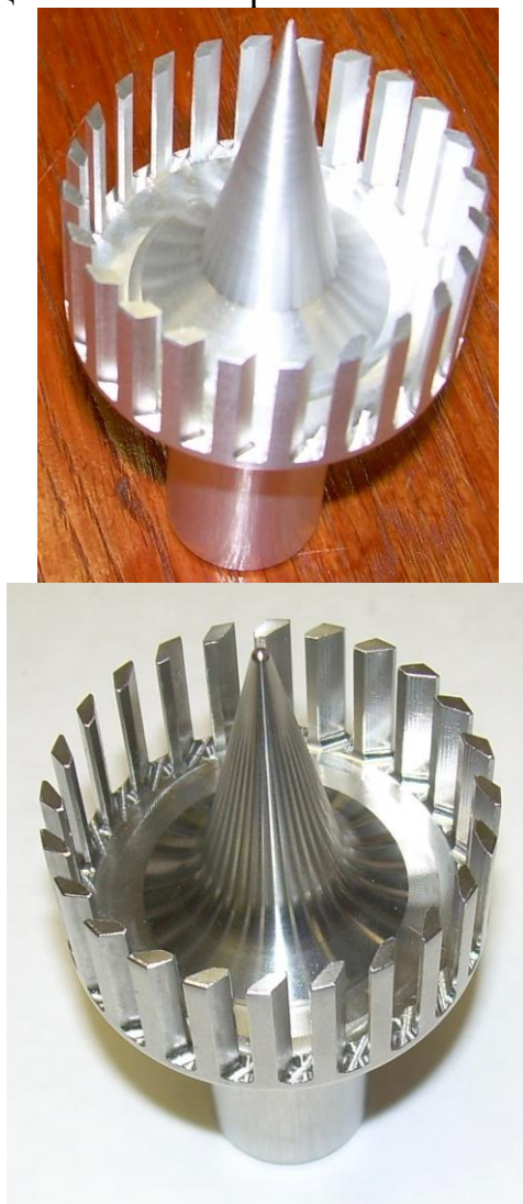
Рисунок 8. Форма мембраны, совмещённая с коническим рефлектором.
