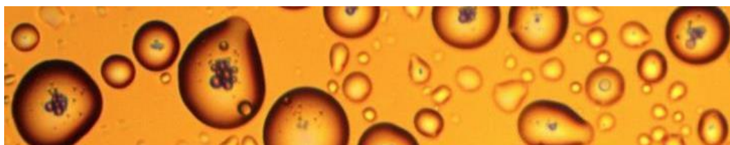
Рисунок 3. Фрагмент фото эмульсии сделанного под электронным микроскопом , видны капсулы эмульсии с несколькими уровнями расположения слоёв , - максимум – 5 микрон и минимум – 120 нанометров ;
