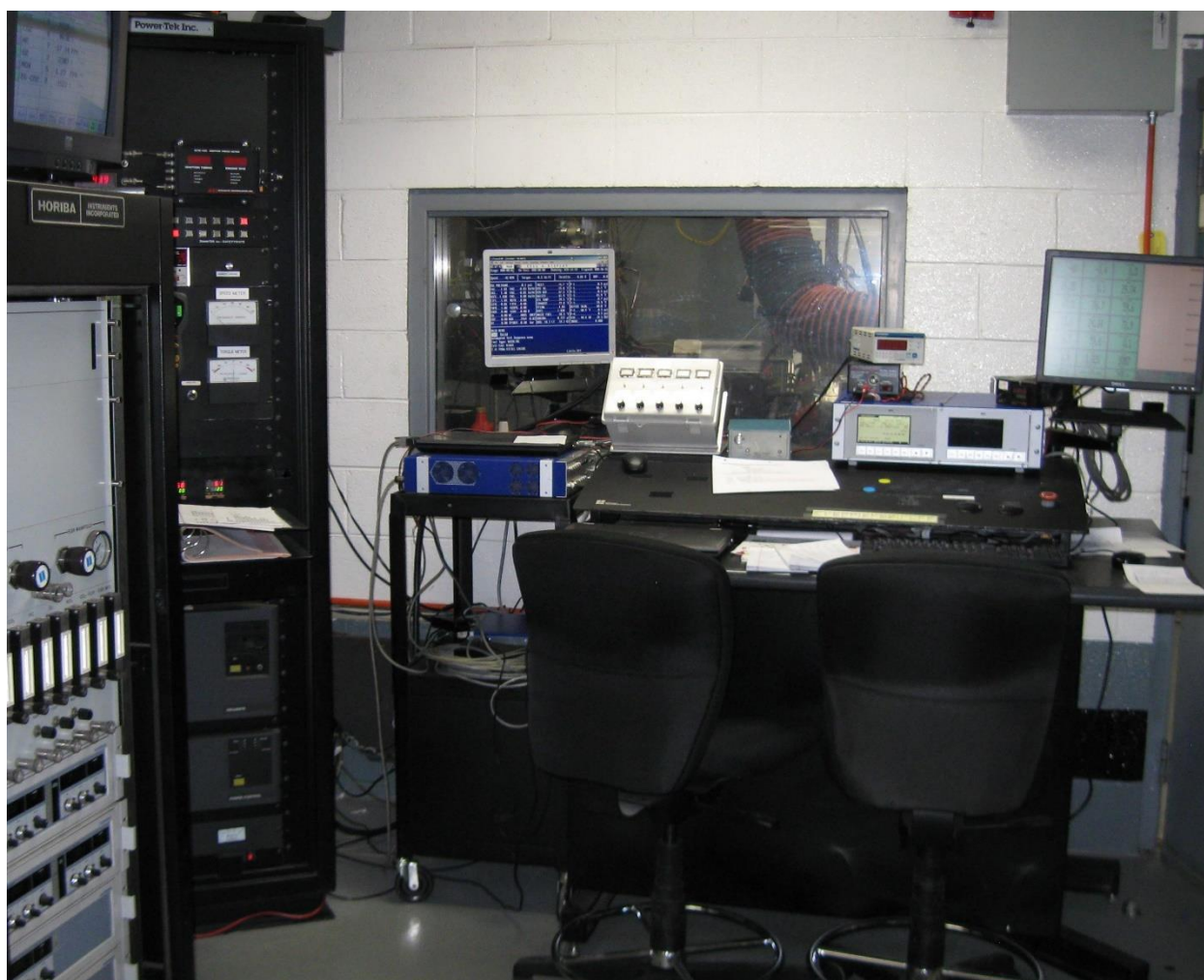
Рисунок 8 , - пример лабораторного комплекса для аналитической проверки соответствия уровня токсичности выхлопных газов требованиям и лимитам действующих экологических стандартов
