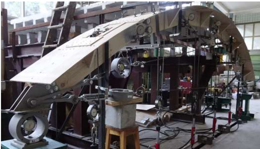
Рис. 1. Стенд випробовування дослідних зразків: а) арка АП-1; б) арка АТ-1
